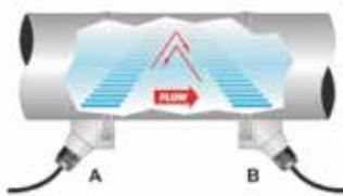
Bu sistemde ana üniteye bağlı olarak çalışan 1 adet sinyal üretici sensör ve 1 adet sinyal algılayıcı sensör bulunmaktadır. Ana üniteye girilen boru bilgilerine göre montaj mesafesi ana ünite tarafından belirlenerek kullanıcıya bildirilir ve sensör montajı bu bilgiye göre gerçekleştirilir.
